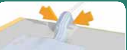
Es importante que el tubo del drenaje esté perfectamente sellado.
